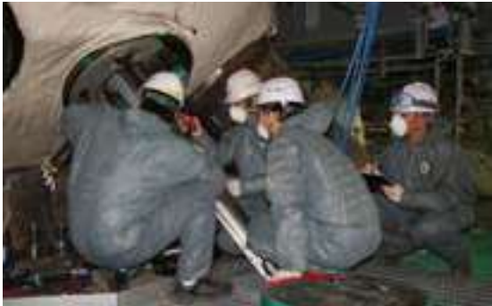
Pengujian Arus Eddy untuk Tabung SG
