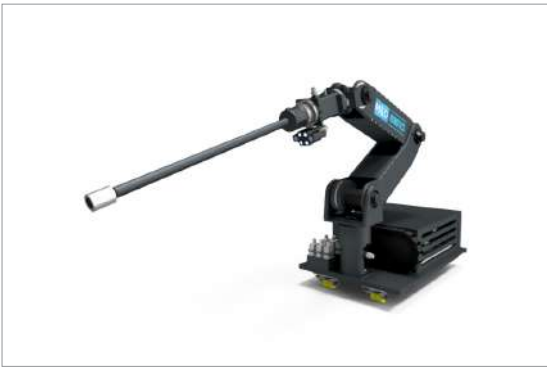
[FilterBot (Robot de remplacement automatique de filtre – système primaire)]
