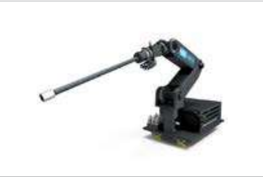
[FilterBot (robot do automatycznej wymiany filtrów w systemie pierwotnym)]
