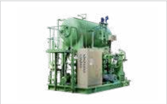
Układ oleju uszczelniającego
